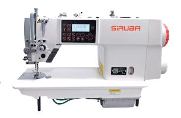
採用內置式直驅伺服馬達,實現了機器的快速啟動和制動的精確度;大幅度降低了噪音和振動,並降低了能耗,與普通的驅動裝置相比,電量耗減 35% 以上,適用於縫製各類襯衫、西服或類似服裝,特別是其衣領、前襟等部位,高速縫製時倒順送料針距能保持完全一致。
